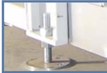
**Fácil ajuste de la altura** del transportador por tornillo.
