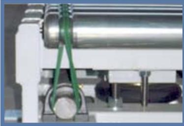
**Una doble correa** conecta cada rodillo con el eje motorizado.
