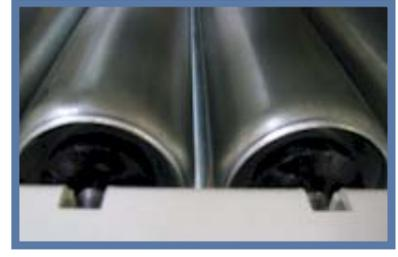
**El paso corto** y el adecuado diámetro de los rodillos, garantizan la estabilidad de las pilas.
