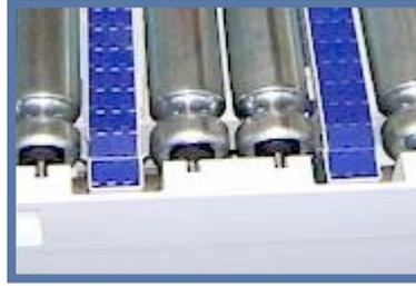
**Paso de las cadenas optimal** con sólo dos rodillos entre dos cadenas.
